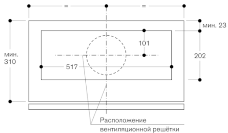
Верхний шкаф с AC 200 и AA 211 812, вид сверху
